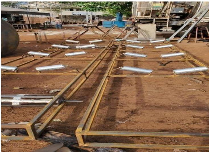
Nous adaptons les modèles de convoyeur en fonction du besoin que ce soit la largeur de la bande, la longueur du convoyeur ainsi que la hauteur pour la décharge.
